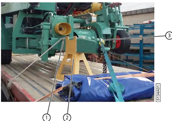
Fig. 49: Fixer la machine sur le camion (avant)
