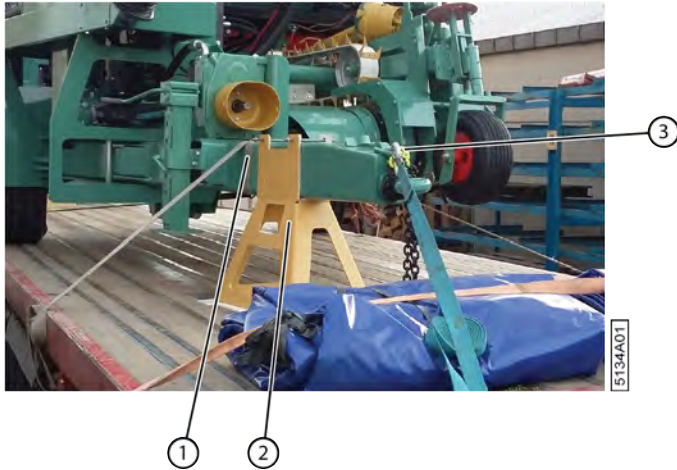
Fig. 46: Fixer la machine sur le camion (avant)
