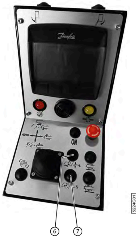
Fig. 79: Régler l'épaisseur de la nappe de lin avec la console de commande
